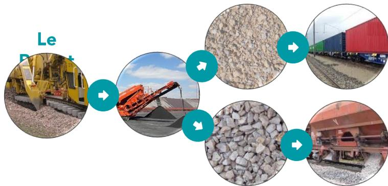
*La Grave issue du criblage est évacuée par train pour être utilisée sur d'autres opérations.*
